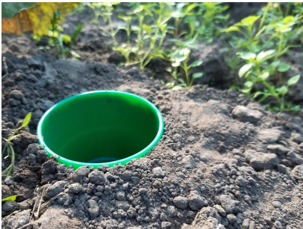
Afbeelding 2. Bodemval voor monitoring van bodemmacrofauna.
