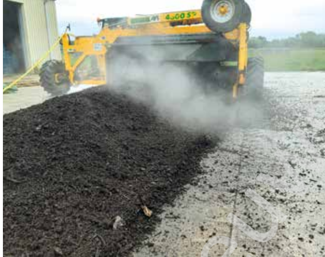
De compostrijl keren zorgt voor afvoer van warmte, CO 2 en vocht, maar wanneer de rijl te droog wordt kan je ook vocht toedienen.
