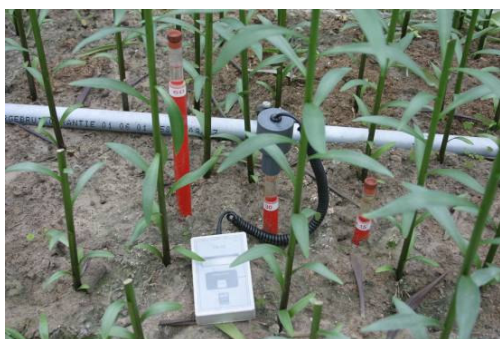
Fig. 6: Tensiometers met rubberen stop waardoorheen met naaldsensor geprikt kan worden en digitaal de zuigspanning afgelezen kan worden bij lelie
