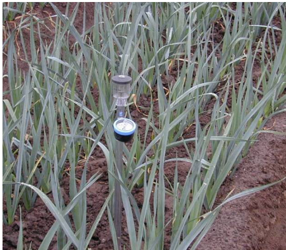
Fig. 8: Tensiometer met manometer voor visuele aflezing van de zuigspanning in de bodem bij prei
