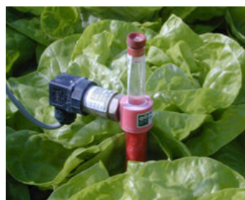
Fig. 7: Elektronische tensiometer aangesloten op klimaatcomputer bij sla
